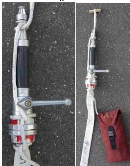
Bild 7 + 8: Mastwurf mit Halbschlag am CM-Strahlrohr mit Schlauch
